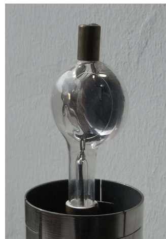
Abbildung 1: Links: Historischer Aufbau zur Untersuchung des Photoeffekts, aus P. Lenard, Annalen der Physik 307 , 359 (1900). Rechts: Photozelle in diesem Experiment
